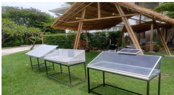
ตู้อบพลังงานแสงอาทิตย์ จำนวน ๓ ประเภท ๑) แบบมีพัดลมระบายความชื้น ใช้พลังงานจากแผงเซลล์แสงอาทิตย์ ๒) แบบไม่มีพัดลม ๓) แบบใช้แผ่นโพลีคาร์บอเนต
