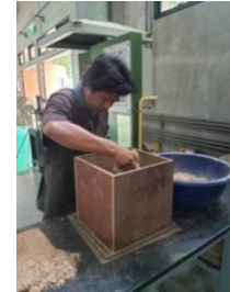
การนำขึ้นไม้ไปทำเป็นแผ่นไม้ด้วยเครื่องทำแผ่น และนำแผ่นไม้ไปอัดด้วยเครื่องอัดร้อนในแนวนราบ
