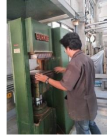
การนำขึ้นไม้ไปทำเป็นแผ่นไม้ด้วยเครื่องทำแผ่น และนำแผ่นไม้ไปอัดด้วยเครื่องอัดร้อนในแนวนราบ
