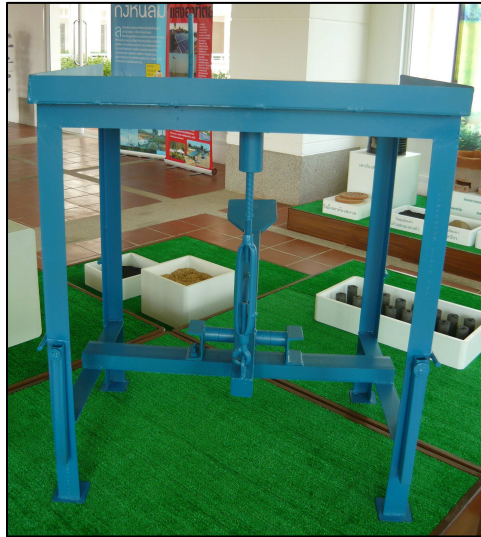
เครื่องอัดแท่งเชื้อเพลิง (แบบแรงงานคน)
